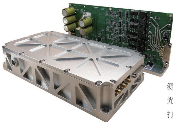
针对激光加工和激光雷达领域，杏林睿光采用自主研发的种子源、隔离器、泵浦源和放大器，特开发窄脉宽、高功率的亚纳秒激光器，具有体积小、重量轻、可靠性高等特点，适用于激光雷达、打标、内雕和其他精细加工应用，该系列产品涵盖1064nm、532nm两种波长，脉冲宽度小于500ps，可接受355nm及更高重频产品定制。
